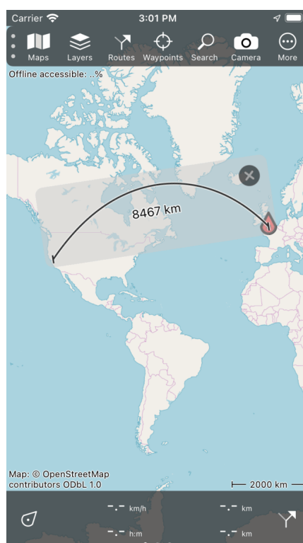
Fig. 3: Curba de pe rigla hării nu este o linie dreaptă, ci o geodezică.
