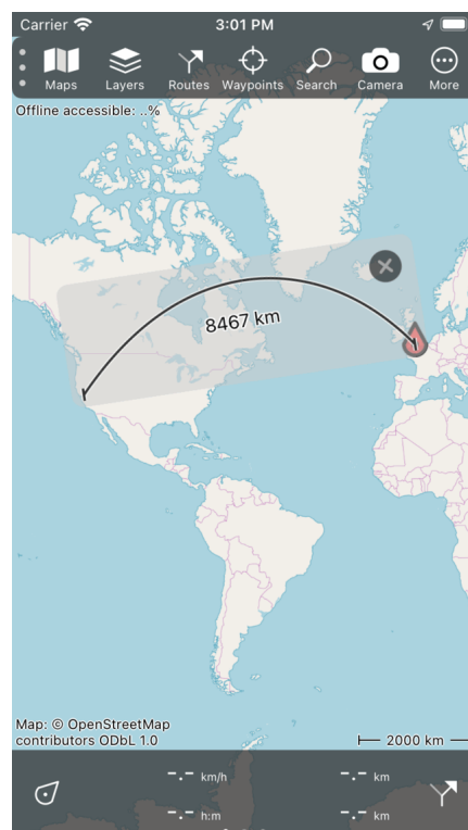
Fig. 3 – La courbe sur la règle de la carte n'est pas une ligne droite mais une ligne géodésique.
