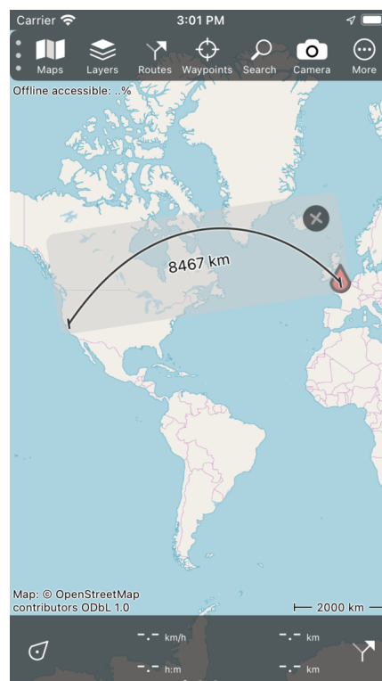
Figura 3: La curva de la regla del mapa no es una línea recta sino una geodésica.
