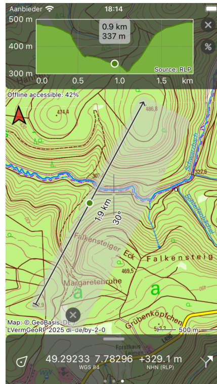
Abb. 2: Mit dem Kartenlineal wird ein Höhenprofil generiert.
